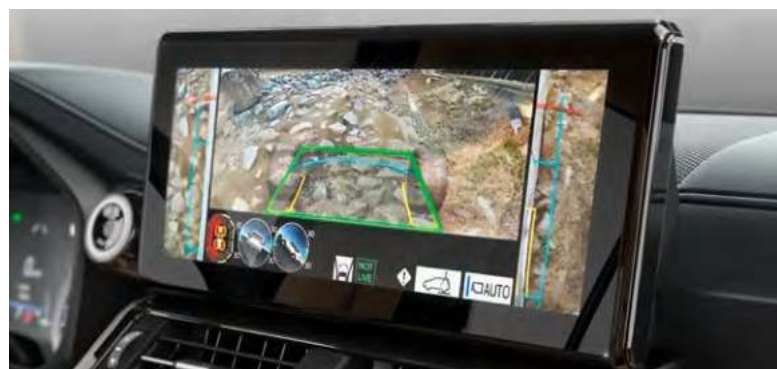
Система помощи при движении по бездорожью Multi-Terrain Monitor с 3D-режимом
