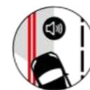
Система оповещения о непреднамеренном пересечении дорожной разметки с функцией удержания автомобиля по центру полосы (LDA).
