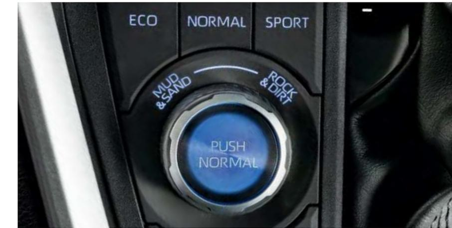
В Toyota RAV4 впервые была применена система выбора режима движения по бездорожью Multi-Terrain Select \*, позволяющая автомобилю адаптироваться под тип дорожного покрытия.
